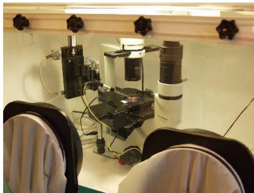
Opstilling til måling af stamcellers pericellulære iltryk
